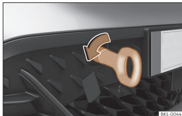
Abb. 150 Stoßfänger vorn rechts: eingeschraubte Abschleppöse.
