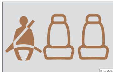
Abb. 15 Kombi-Instrument: Gurtstatusanzeige für die hinteren Sitzplätze.
