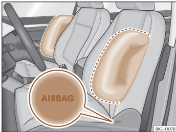
Abb. 29 Seitenairbag im Fahrer- und Beifahrersitz.
