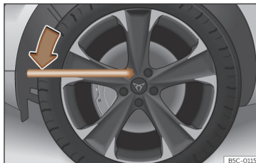
Abb. 167 Radwechsel: Radschrauben lockern.
