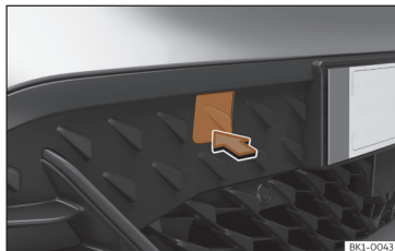
Abb. 149 Auf der rechten Seite des vorderen Stoßfängers: Abdeckung entfernen.
