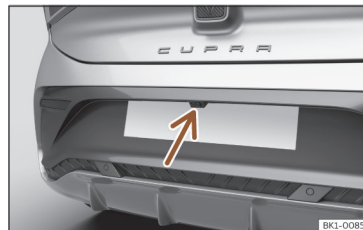
Abb. 100 Im Stoßfänger hinten: Einbauort der Kamera des Rückfahrassistenten.
