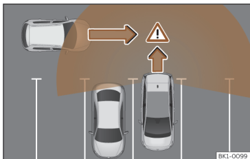
Abb. 115 Schematische Abbildung des Ausparkassistenten: Überwacher Bereich des ausparkenden Fahrzeugs.
