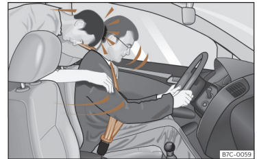
Abb. 18 Der nicht angegurte Mitfahrer auf dem Rücksitz wird nach vorn auf den angegurten Fahrer geschleudert.
